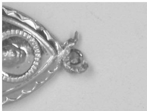
图4 造假的吊坠配件中藏铜材料
