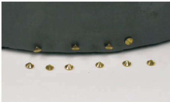
图7 部分HPHT合成钻石被磁铁吸住
