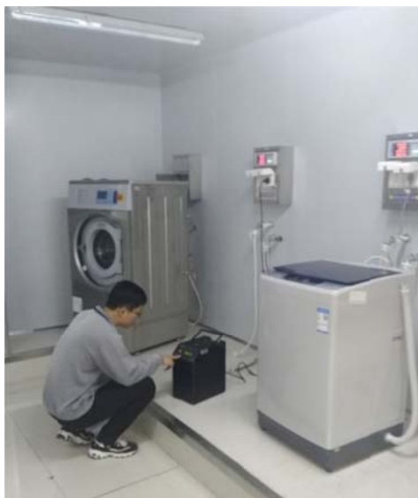
图 4 洗衣机能效计量检测系统校准
