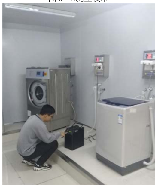
图4 洗衣机能效计量检测系统校准
