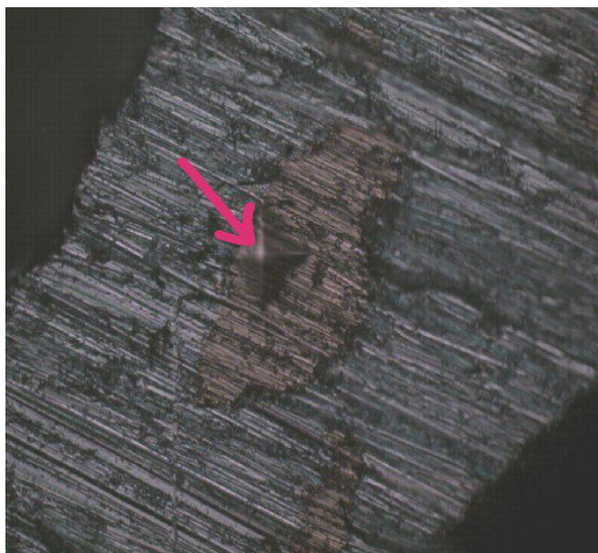
图 9 互熔物维氏硬度高达 307HV
